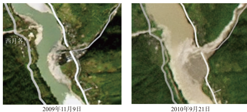
图3 基于RapidEye影像的怒江干流典型泥石流暴发前后的遥感解译对比图(东月谷溢玛)
