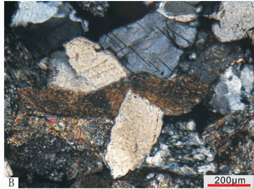
B 庄3, 4169.94m, 千枚岩软岩强烈塑性变形, 常规薄片, 正交光
