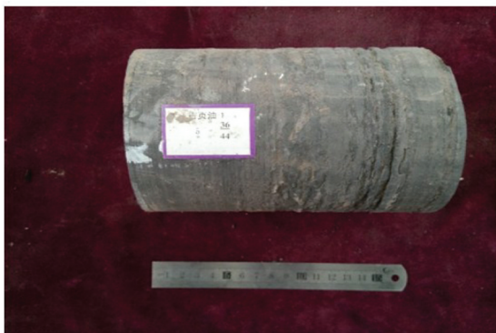
(e) 2460.2m, 灰黑色泥岩, 整体较纯, 局部发育砂质薄夹层, 发育水平层理 浅湖泥微相
