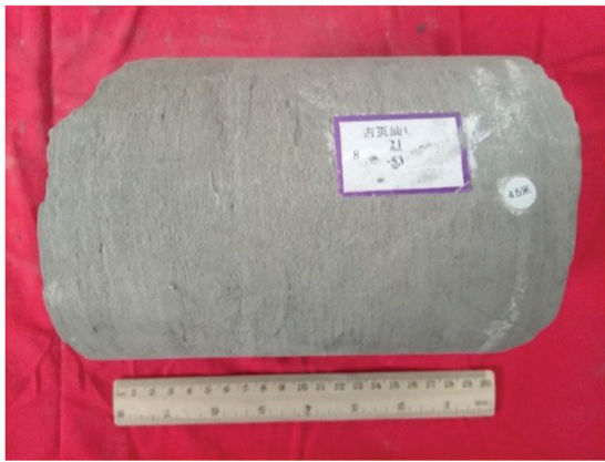
(a) 2481.7m, 灰色粉砂岩, 发育平行层理, 水下分流河道微相
