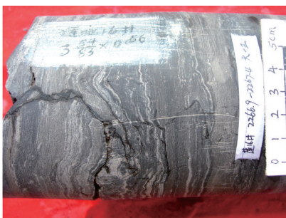
b. 莲16井, 2266.9~2267.4 m, 大一三亚段, 沿缝合线可见溶孔和溶蚀扩大缝
