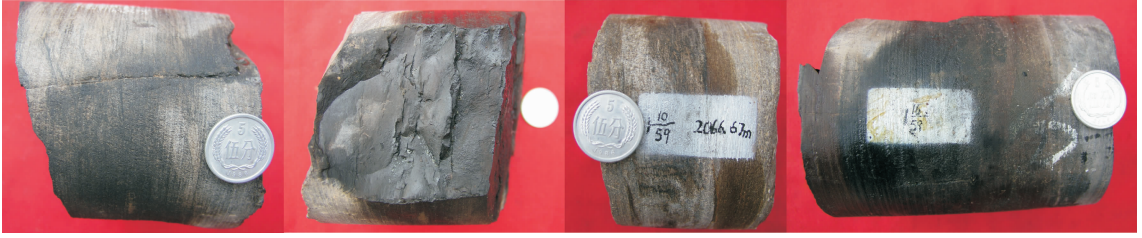
图 4 吴堡地区长 73 生油岩中浊积砂体裂缝分布及含油特征
