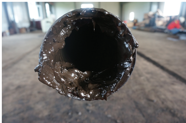
图1 出心时发现钻井液增稠严重现象
