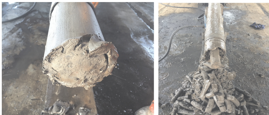
图2 出心时发现重晶石包裹在岩心表面
