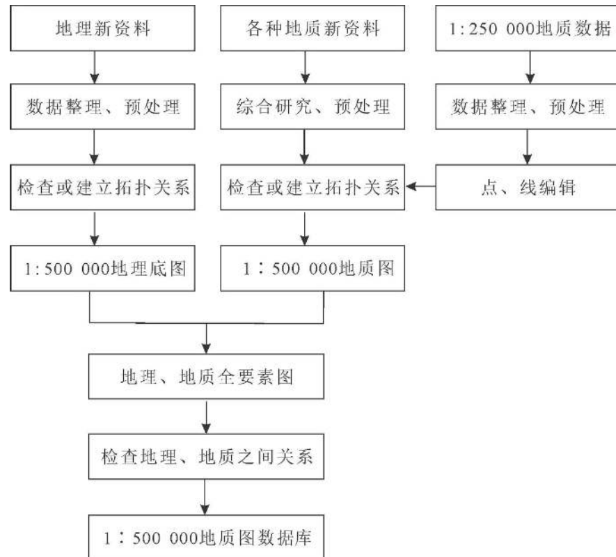
图3 晋南-豫西地区1:500 000地质图空间数据库工作流程图
