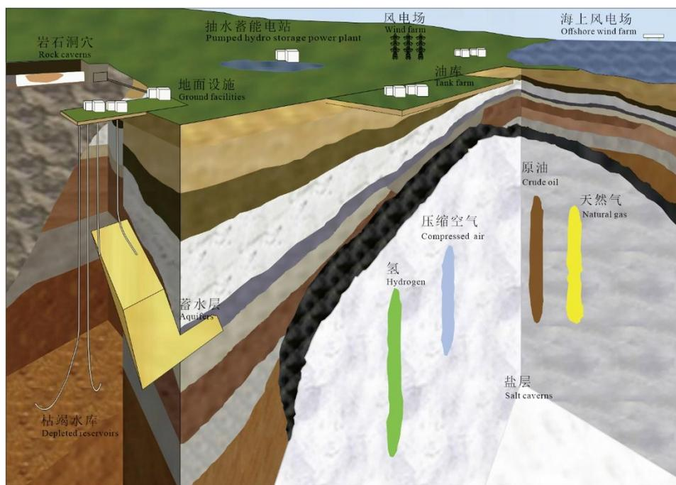
图 1 地下空间中潜在的储库主要有盐穴、含水层、枯竭油气藏和废弃矿坑（修改自 Crotagino et al., 2018 修改）
