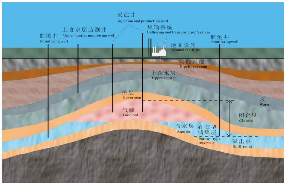
图 3 含水层地下储气库基本结构示意图（据贾善坡等，2016 修改）
