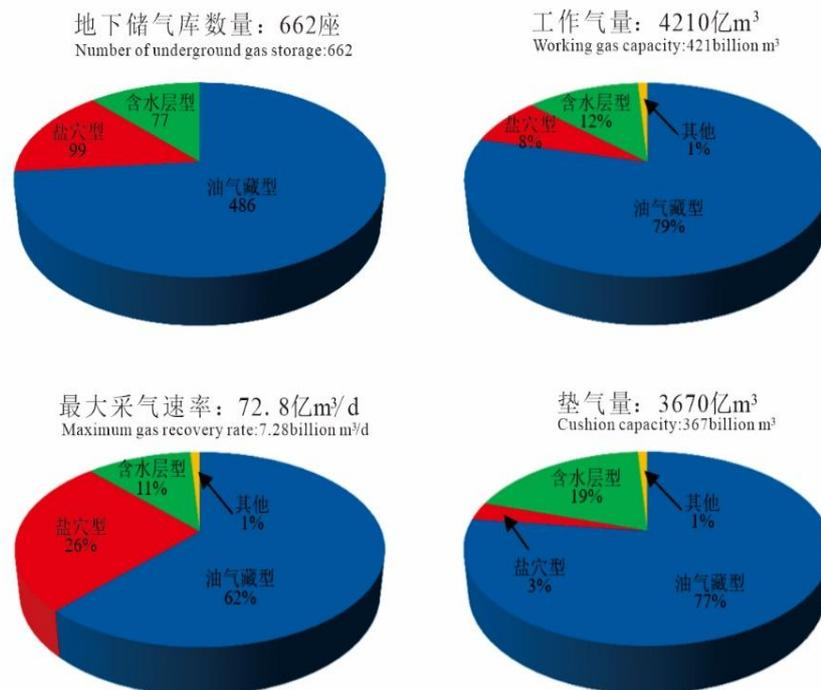
图 4 世界上利用地下空间建设储气库类型及其关键参数
