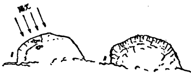
在溫度變化下岩石的表面就這樣崩裂了
