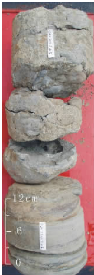
图 4 河道底部冲刷面
