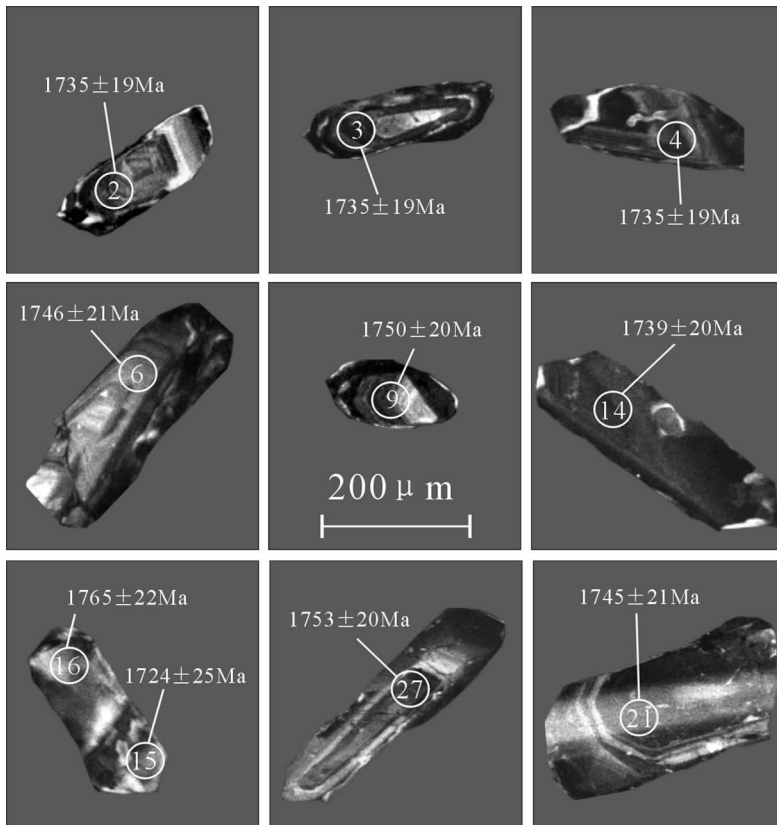
图 2 宝鸡岩基胡店变形侵入体部分锆石阴极发光图像 圈内数字表示 U-Pb 分析点,其他数字表示 ^{207}\text{Pb}/^{206}\text{Pb} 表面年龄
