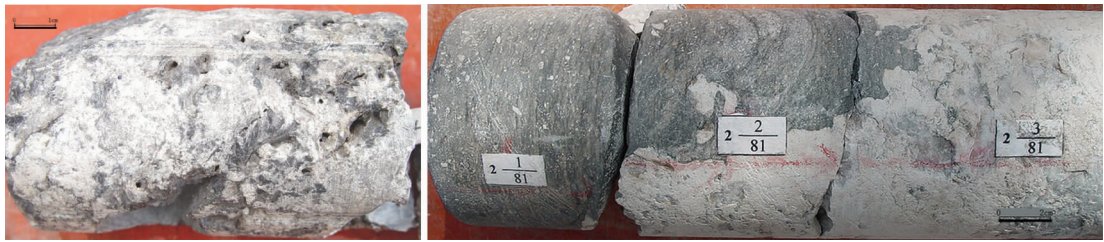
图 3 良里塔格组顶部的风化壳岩溶特征(左:LN51井,右:LG37井)
