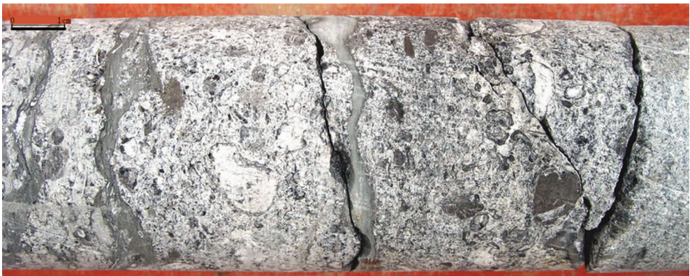
图 6 LN51 井桑塔木组滩相砂屑生屑灰岩
