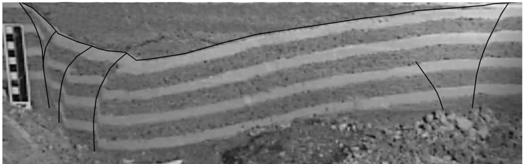
图 7 天窗式塌陷破火山口的实验模拟 [13]
