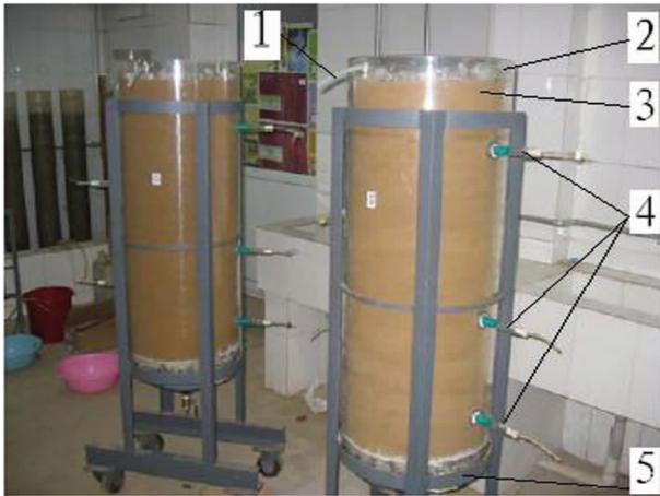
图 1 土柱试验装置图
