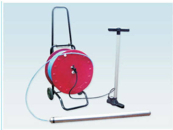
图 7 气控式定深取样器 Fig.7 Depth preset sampling system
