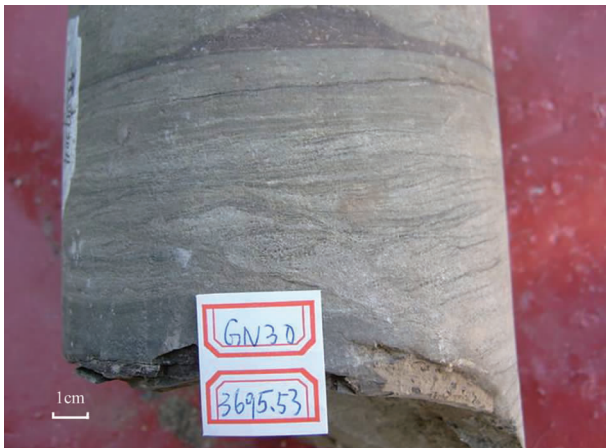
图 2 孤南 30 井,3694.80 m,渠模、泄水构造
