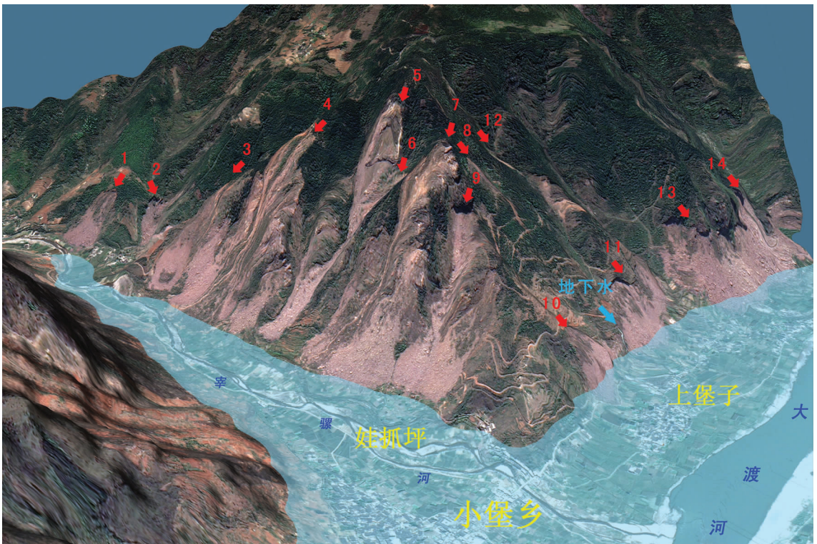
图 4 小堡崩塌群瀑布沟电站蓄水淹没模拟图(图中数字 1~14 为崩塌编号)
