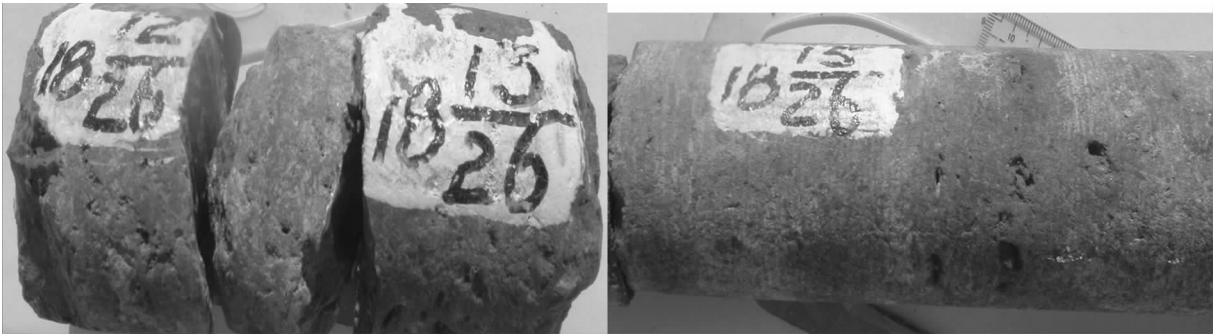
图 5 中 1 井 18 次取心溶蚀孔洞发育特征
