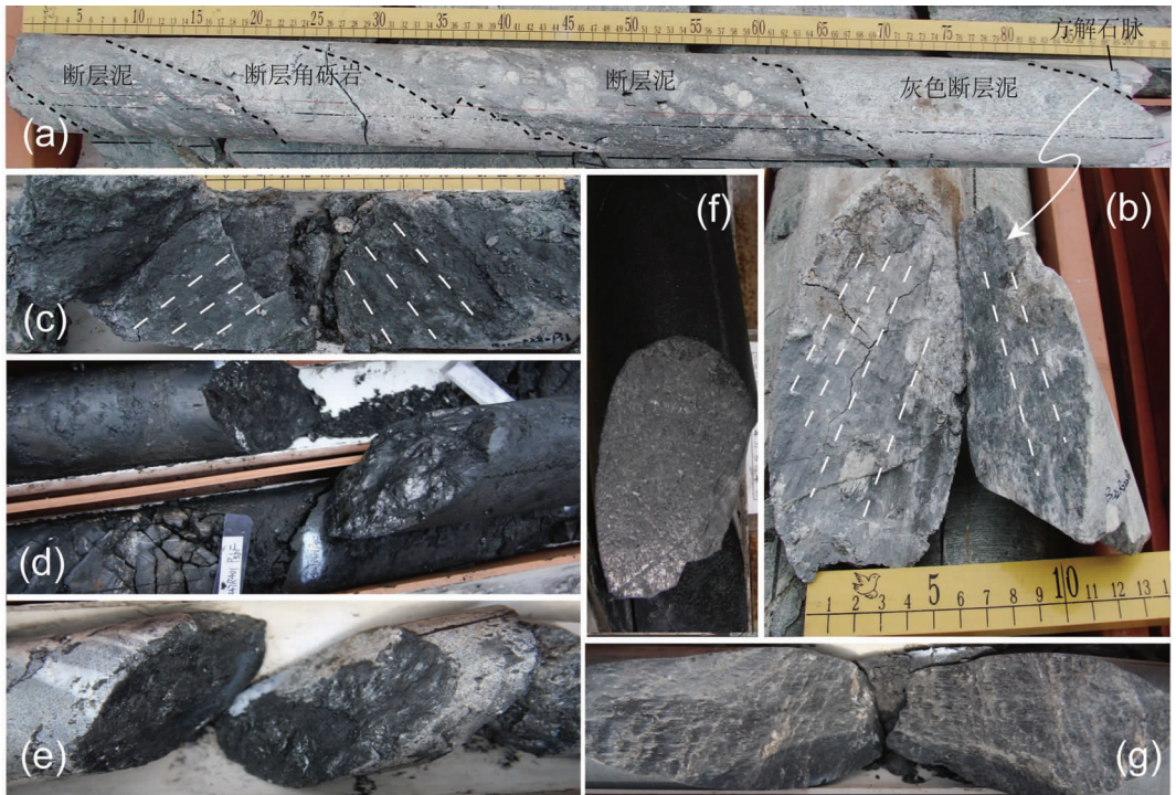
图 8 WFSD-1 岩心中断层岩变形构造特征
