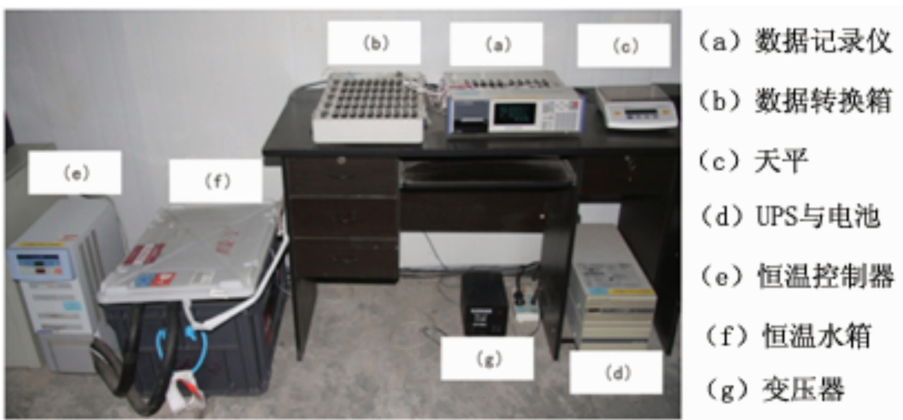
图 1 ASR 法地应力测试设备 Fig.1 Test equipment of ASR method
