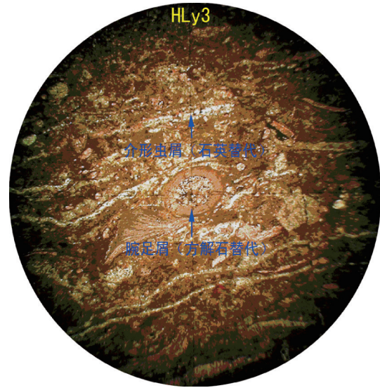
图8 生物屑泥晶灰岩照片 (单偏光, 染色, 目镜10×, 物镜4×)
