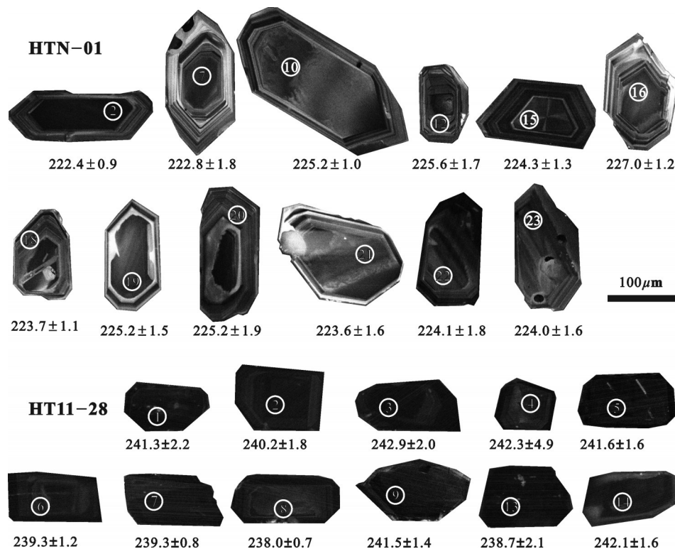
图4 花岗闪长岩及正长花岗岩锆石阴极发光图像和 ^{206}\text{Pb}/^{238}\text{U} 年龄(Ma)
