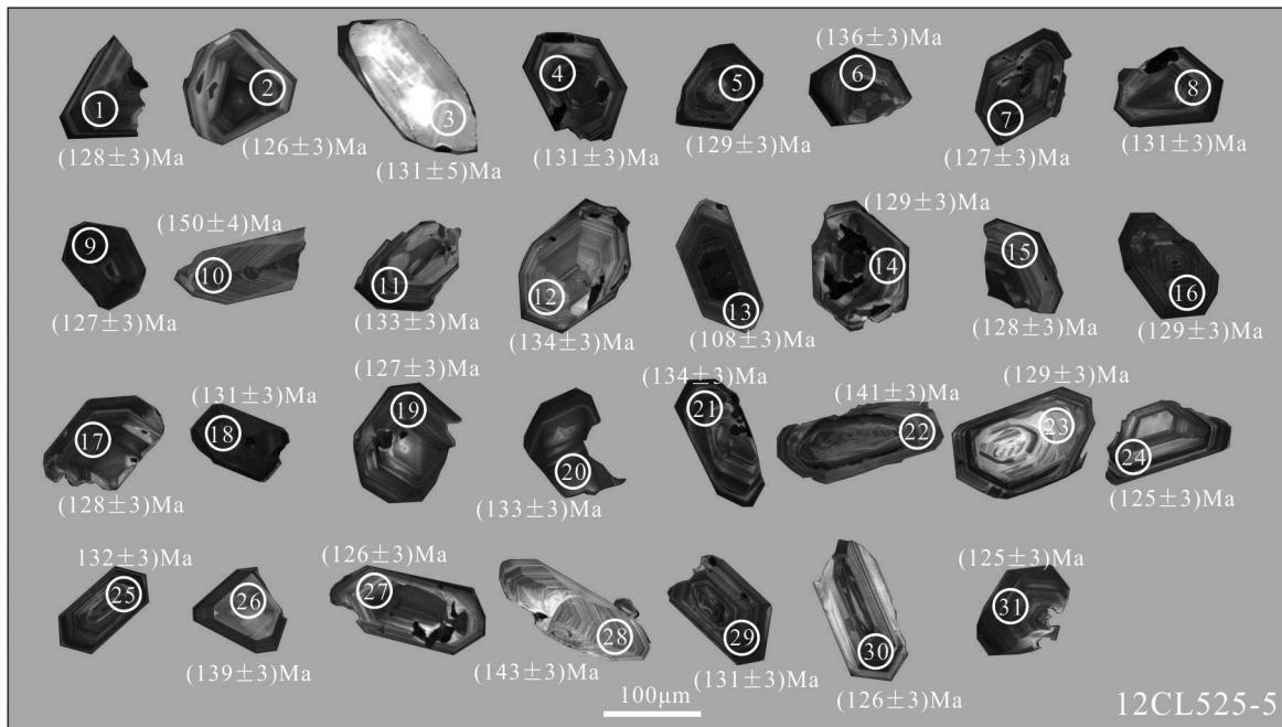
图16 长英质细晶岩(12CL525-5)锆石锆石阴极发光图像 Fig.16 CL image of zircons of felsic aplite (12CL525-5)
