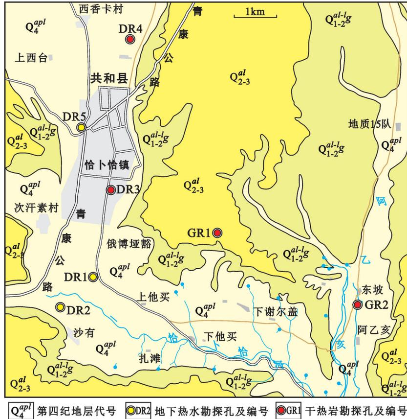
图8 恰卜恰地区干热岩勘探孔分布图
