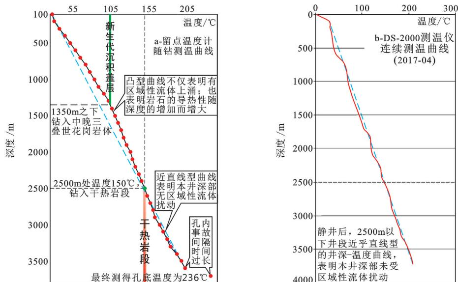
图9 GR1干热岩勘探孔井深-温度曲线图
