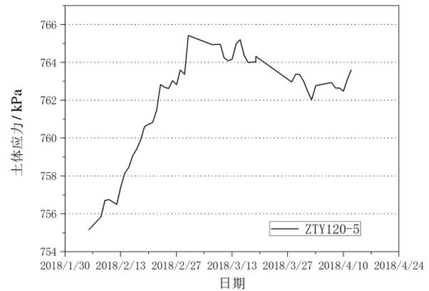
图12 地下120 m处垂向振弦式土压力计测得压力值与时间关系曲线图
