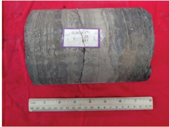
(d) 2469.23m, 灰黑色含粉砂质泥岩, 波状-透镜状层理, 分流间湾微相
