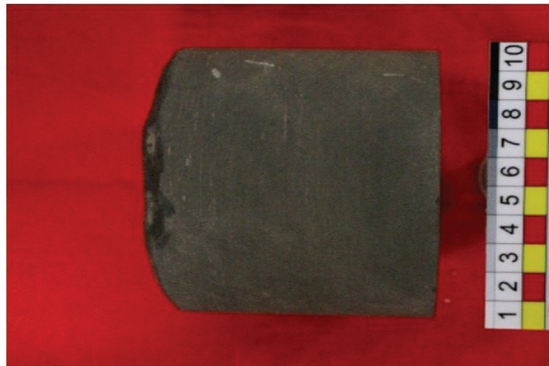
(f) 2442.5m, 灰黑色泥岩, 黄铁矿发育, 层理缝发育, 半深湖-深湖泥微相
