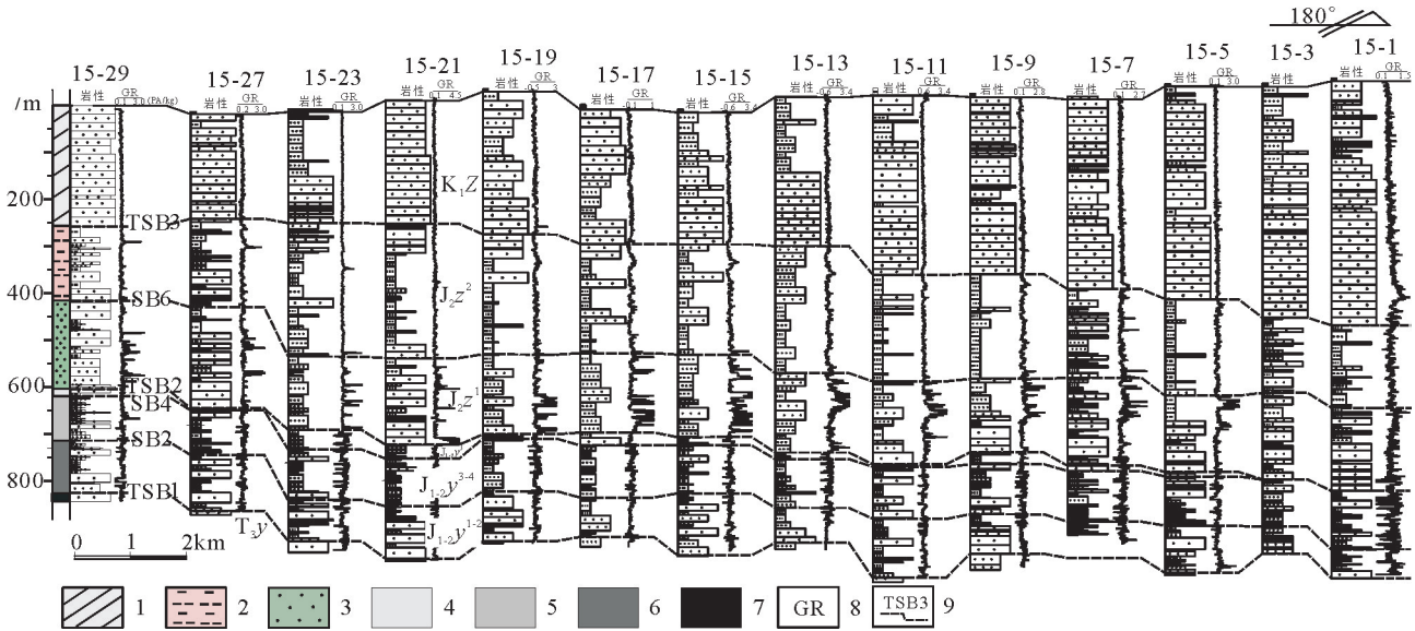
图7 鄂尔多斯盆地大营地区侏罗系延安组—直罗组关键层序界面及地层结构特征(15勘探线) 1—下白垩统志丹群;2—中侏罗统直罗组上段;3—中侏罗统直罗组下段;4—中—下侏罗统延安组五段;5—中—下侏罗统延安组三至四段; 6—中—下侏罗统延安组一至二段;7—上三叠统延长组;8—自然γ曲线;9—层序界面
