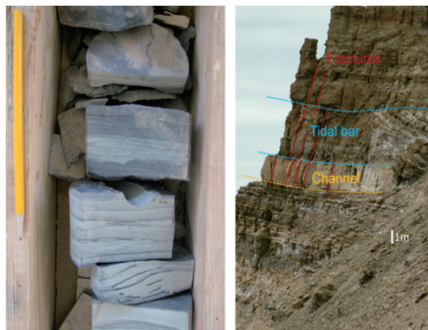
图5 储存场地的地质特征(据 Phil Ringrose, 2019) (左图阿尔及利亚克雷奇巴石炭纪储集单元潮汐三角洲岩相典型岩心样品;右图格陵兰中侏罗纪尼尔-克林特组潮汐三角洲沉积结构的露头代表)
