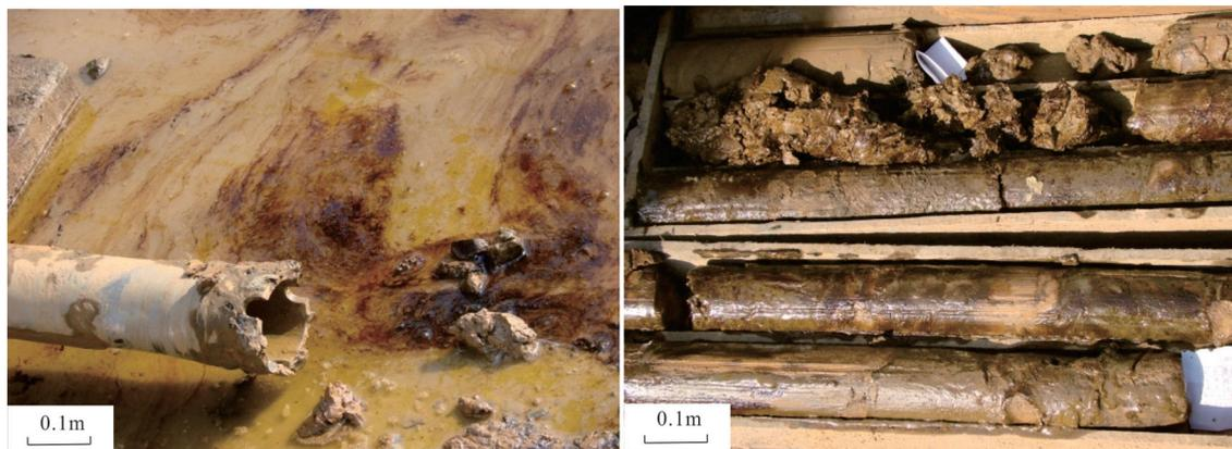
图20 钻孔岩心和地下水中的有机污染物
