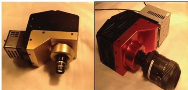
图2 VNIR 可见光-近红外及 SWIR 短波红外成像光谱仪
