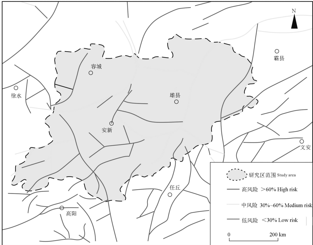
图3 天然断层滑动趋势分布图 Fig.3 Natural fault slip trend distribution
