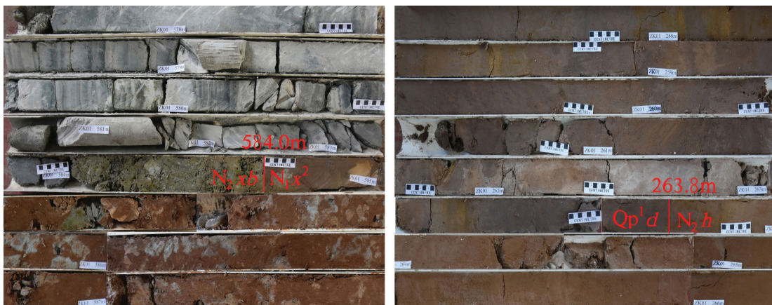
图4 ZK01孔地层分界处岩性变化特征
