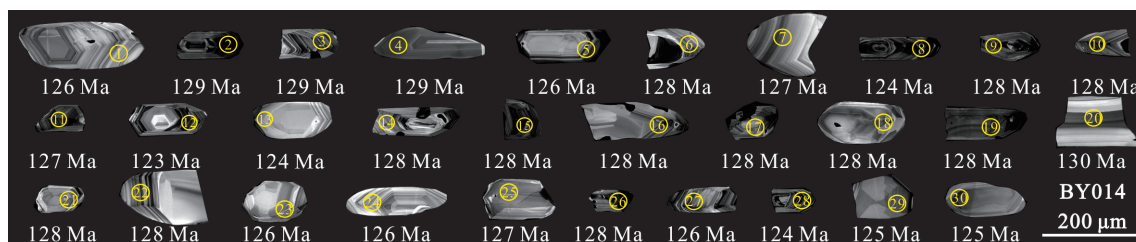
图3 白云金矿煌斑岩的锆石CL图像特征以及U-Pb定年、Hf同位素测试点位
