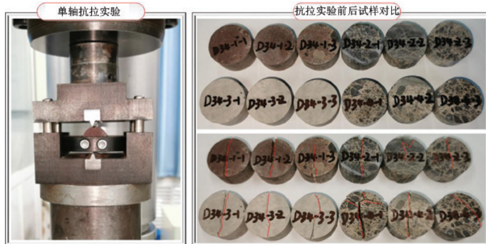
图4 拉伸实验装置及实验前后样品照片
