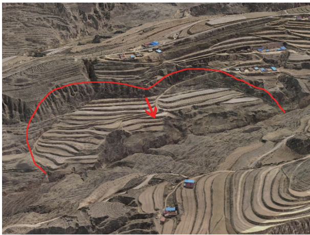
图 7 滑坡体条状纹理(镜头方向 90°) Fig.7 Striped texture of landslide mass (Lens direction 90°)
