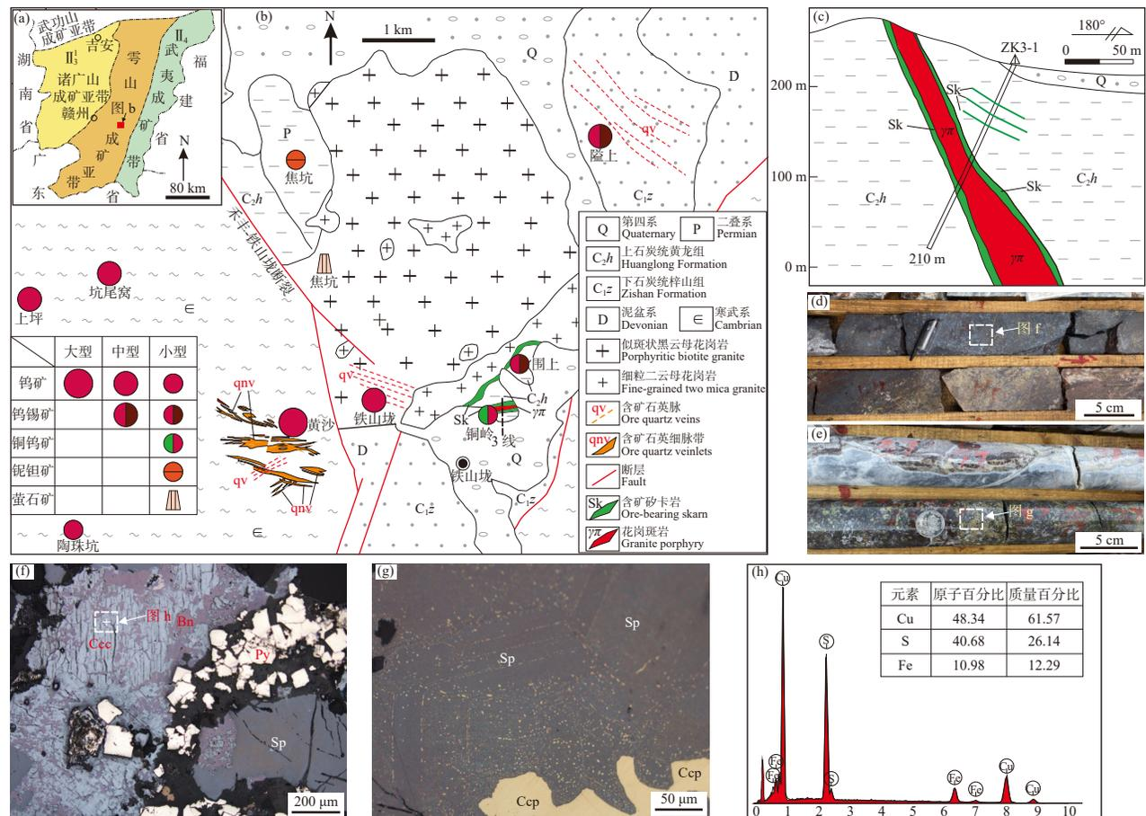
图1 铁山垅钨矿田区域成矿区划位置(a)、地质简图(b)和铜岭矿区3号勘探线地质剖面图(c)、辉铜矿矽卡岩照片(d和f)、黄铜矿矽卡岩照片(e和g)、辉铜矿电子探针测试结果(h)
